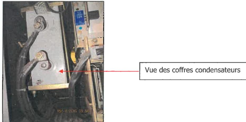
**Figure 3 – Retrait des condensateurs des voitures**
